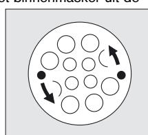
**Spreekmembraan resp. O-ring vervangen:** Het binnenmasker uit de gleuf van de schroefring trekken. Schroefring met stiftsleutel R 26 817 losschroeven.
