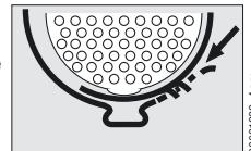
Equipaggiare il nuovo elemento di raccordo con membrana orale in modo che le marcature centrali dell'elemento di raccordo e del corpo della maschera coincidano. Montare l'anello di scorrimento e la nuova fascetta. Disporre il gancio in modo che la fascetta sia possibilmente ben tesa.
