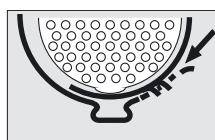
Beugel met behulp van een schroovedraaier open wrikken. Beugel alsmede glirring en steunplaat weghalen. Gelaatstukaansluiting uit het maskerlichaam trekken. Nieuwe gelaatstukaansluiting met spreekmembraan uitrusten en zo monteren dat de centrale merktekens van gelaatstukaansluiting en maskerlichaam op elkaar liggen. Glirring en nieuwe beugel monteren. Haak zo ophangen dat de beugel zo strak mogelijk zit.
