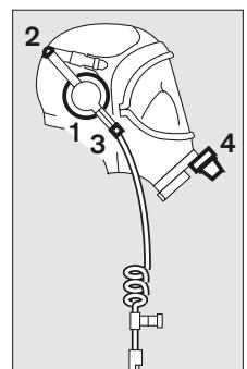
**Remplacement de l'oculaire :** dévisser les deux vis de serrage. Avec un tournevis, écarter le cadre de serrage aux jointures, puis le retirer vers le haut et vers le bas. Si nécessaire, retirer la plaque de support. Dégager l'ancien oculaire de la monture en caoutchouc.
