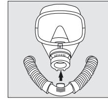
**Vollmaske anlegen:** Bärte und Koteletten im Dichtungsbereich der Vollmaske verursachen Leckagen! Entsprechende Personen sind für das Tragen der Vollmaske ungeeignet. Brillenbügel im Dichtungsbereich verursachen ebenfalls Leckagen. Maskenbrille verwenden. Trageband ausknöpfen. Kinn in Kinnmulde einlegen.
