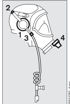
**Sostituzione del visore:** Svitare le due viti di serraggio tenendo stretti i dadi esagonali. Con un cacciavite separare i due telai di serraggio ed estrarli verso l'alto e il basso. Se necessario, rimuovere la piastra di sostegno. Staccare il vecchio visore dal suo telaio di gomma.
