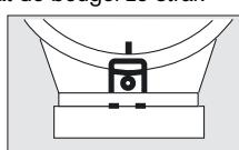
**Eenrichtingskleppen van de regelventielen van het binnenmasker vervangen:** Oude ventielschijven naar binnen wegtrekken. Pennen van de nieuwe ventielschijven van binnen in de boring steken en in de richting van de voorzetruit trekken tot de achtersnede van de pen zichtbaar wordt. De ventielschijven moeten binnen gelijkmatig liggen.
