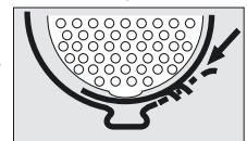
raccordement de la jupe de masque. Equiper le nouveau raccord d'une membrane phonique et le monter dans la jupe de masque de façon à ce que les repères centraux du raccord et de la jupe de masque coïncident.
